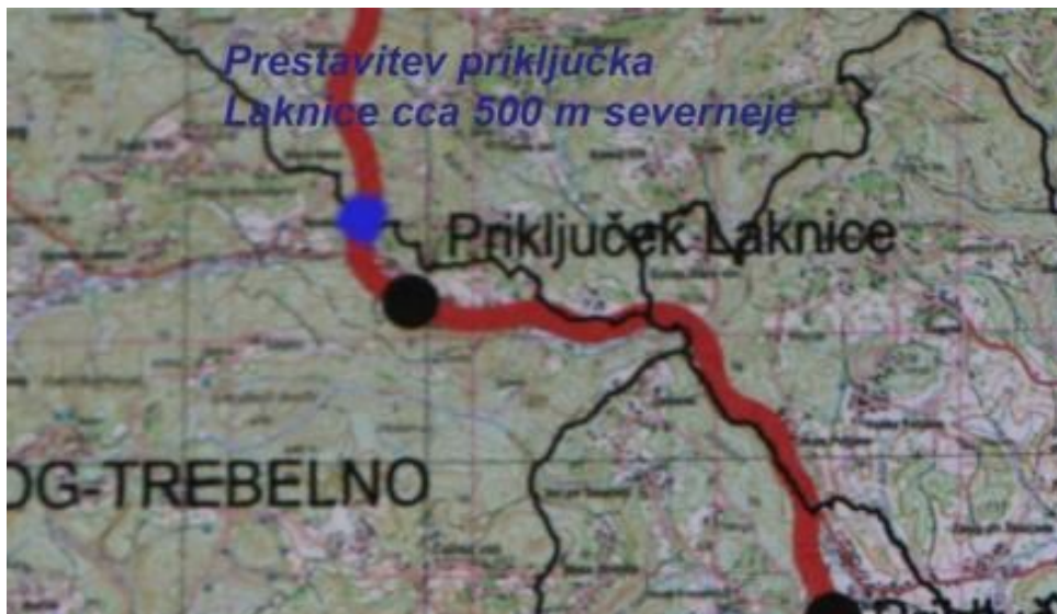
Slika 3: Shematski prikaz prestavljene lokacija priključka Laknice cca 500 m severneje (modro)
