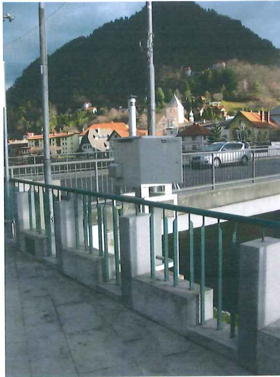
Slika 2: Postavljena merilna postaja Skypost PM na merilnem mestu (foto: Arhiv Eurofins ERICo, 08.12.2017).
