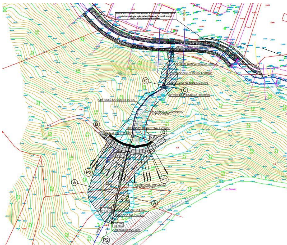
Slika 18: Prikaz sanacije zemeljskega plazu severozahodno od pridobivalnega prostora kamnoloma (vir: Načrt sanacije plazu (Gprocom d.o.o., oktober 2017))
