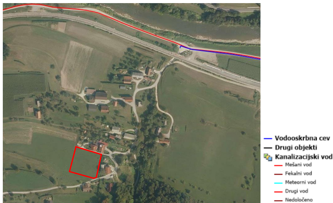
Slika 5: Prikaz vodovodnega in kanalizacijskega omrežja (vir: iObčina, september 2017)
